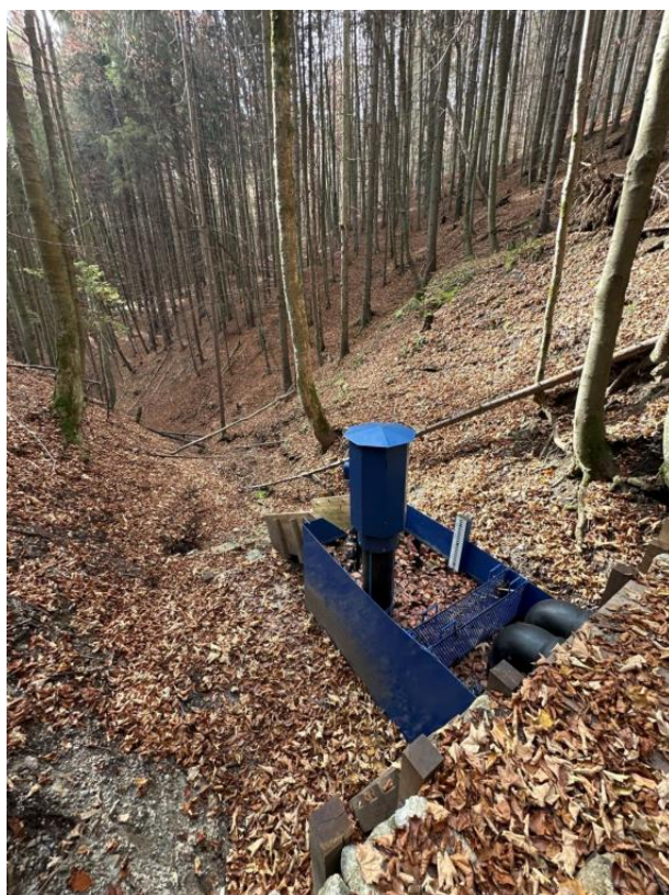
Občasný prameň spring under the Havrania skala Mt. with an old Slovak Hidromet. Service (SHMÚ) gauging object - detail. Photo: Marcel Wolf / www.mapy.cz
